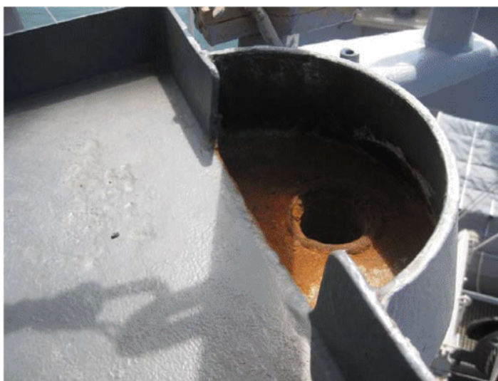
D. Coaming (Waterway Bar) At Deck Edge
