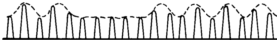
(D) RECTIFIED MIXED - FREQUENCY SIGNAL
