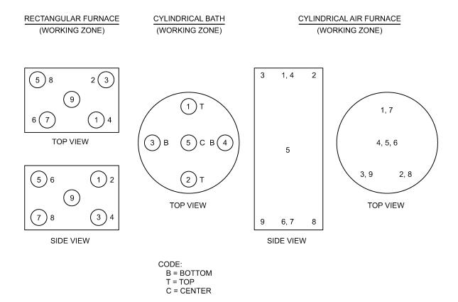
ONLY CIRCLED TEST LOCATIONS ARE REQUIRED FOR BATH - TYPE FURNACES LESS THAN 75 CUBIC FEET.
