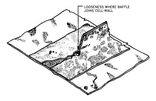
Figure 9-7. Loose Baffles
