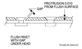
Figure 4-9. Rivet Head Criteria
