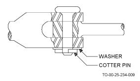
Figure 4-6. Clevis Pin
