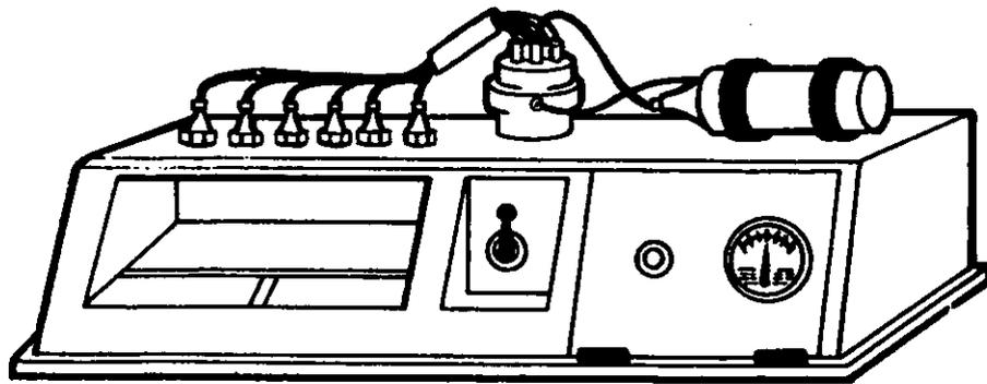
FIGURE 1. IGNITION SYSTEM DEMONSTRATOR
