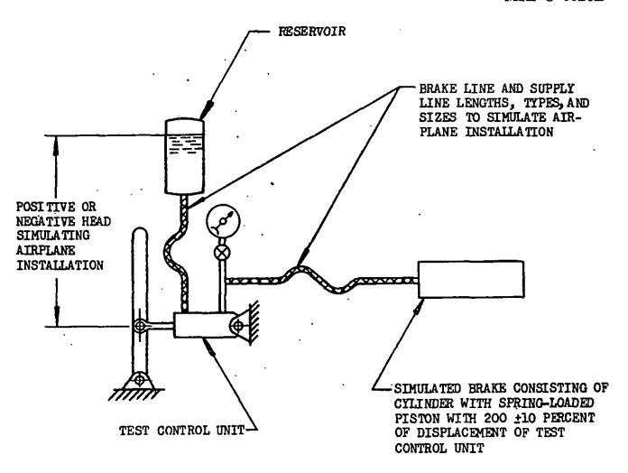
PUSH-TYPE CONTROL UNIT SHOWN IN THIS SCHEMATIC DIAGRAM. REVERSE PORTING FOR PULL-TYPE CONTROL UNIT.
