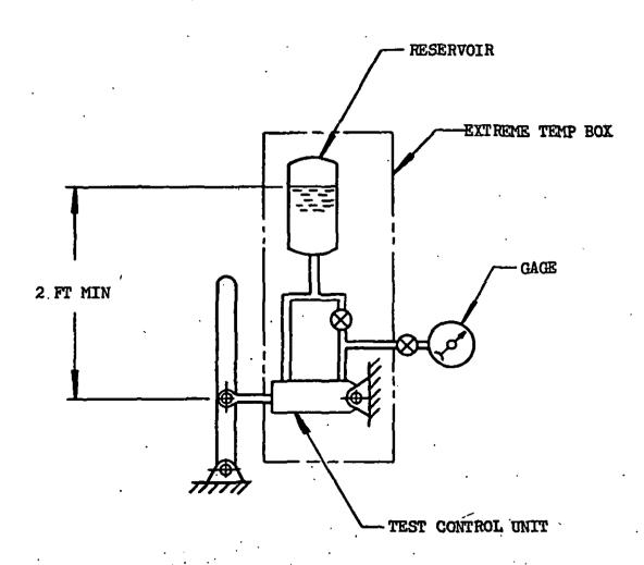
PUSH-TYPE CONTROL UNIT SHOWN IN THIS SCHEMATIC DIAGRAM. REVERSE PORTING FOR PULL-TYPE CONTROL UNIT.
