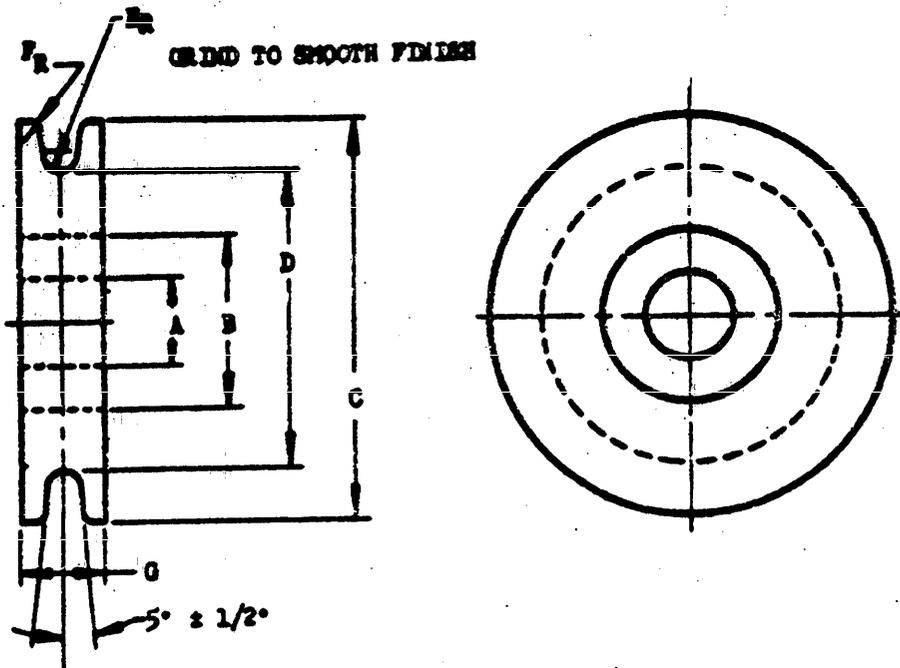
NOTE: FIT PULLEYS WITH SUITABLE BALL OR ROLLER BEARINGS.
