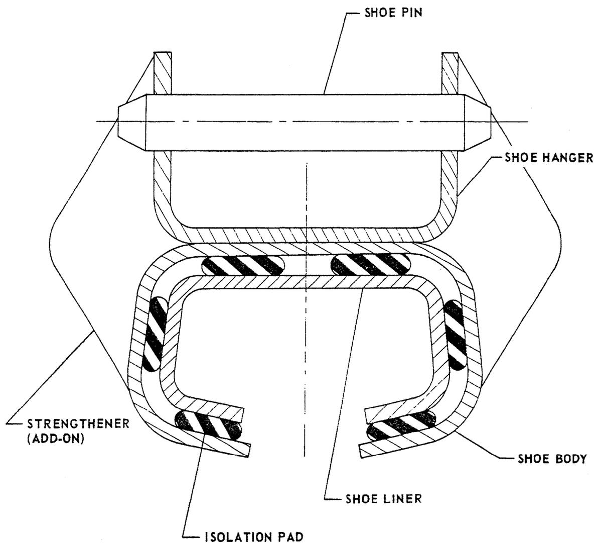
FIGURE 1, VIBRATION ISOLATION SHOE CROSSECTION
