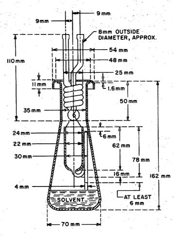
FIGURE I. EXTRACTION EQUIPMENT
