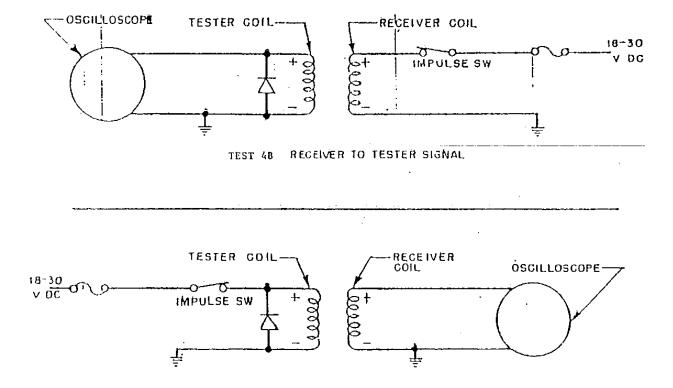
TEST 4A TESTER TO RECEIVER SIGNAL
