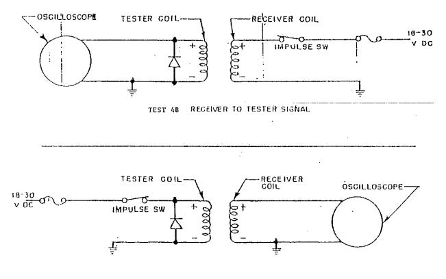
TEST 4A TESTER TO RECEIVER SIGNAL
