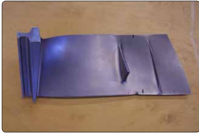
Figure 10-59. Fan blade damage.
