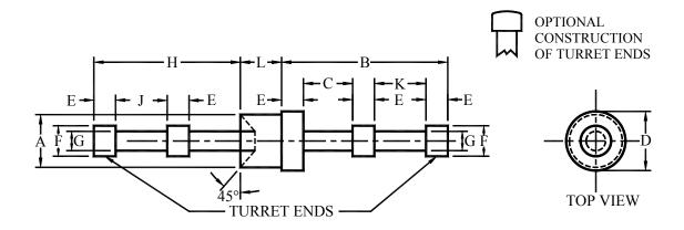
FIGURE 1. <u>Double - double feedthru stud terminal</u>.
